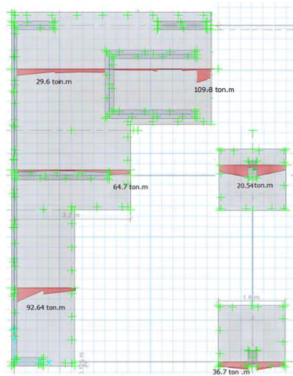
Figura 54: Momentos mínimos producidos por la envolvente en el eje Y-Y Obtenido del software SAFE 2016
