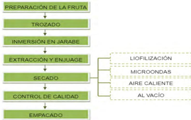
Figura 41: Flujo de proceso para la obtención de fruta deshidratada empleando deshidratación osmótica
