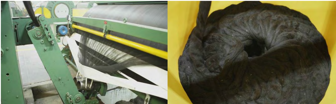
Figura 31: La fibra peinada es colocada en barriles de plástico, mientras la mecha se va limpiando y afinando
