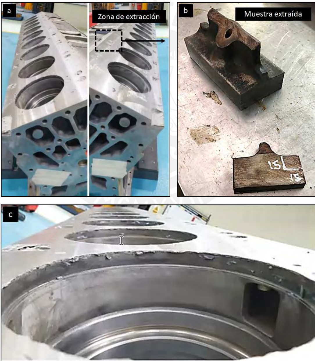
Figura 2. (a) Componente Monoblock, (b) extracción de muestra, (c) Asiento de cilindro en ventana de galería de refrigeración.
