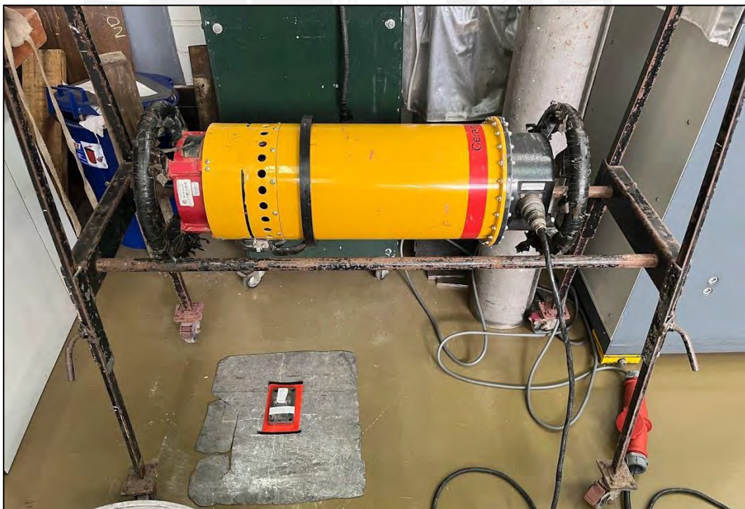
Figura 2.11. Armado de la fuente, Tubo rayos x - BALTEAU NDT.
