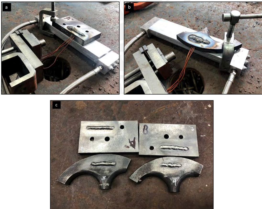
Figura 2.14. Ensayos EA, (a) muestra de soldadura del monoblock, (b) muestra de soldadura de la culata y, (c) cupones soldados del monoblock y culata.
