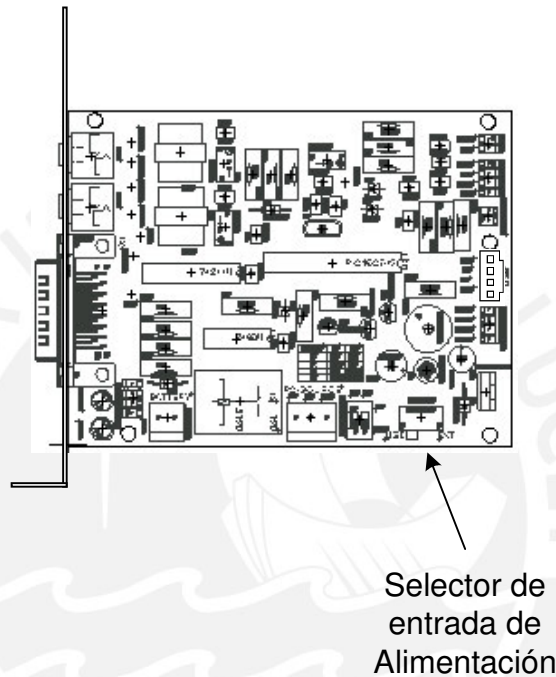
Figura 5.8.1 Vista del selector de alimentación del dispositivo
