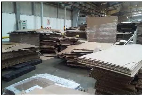
Figura 45: Almacenamiento de planchas de cartón corrugado en desorden y sin ningún control.
