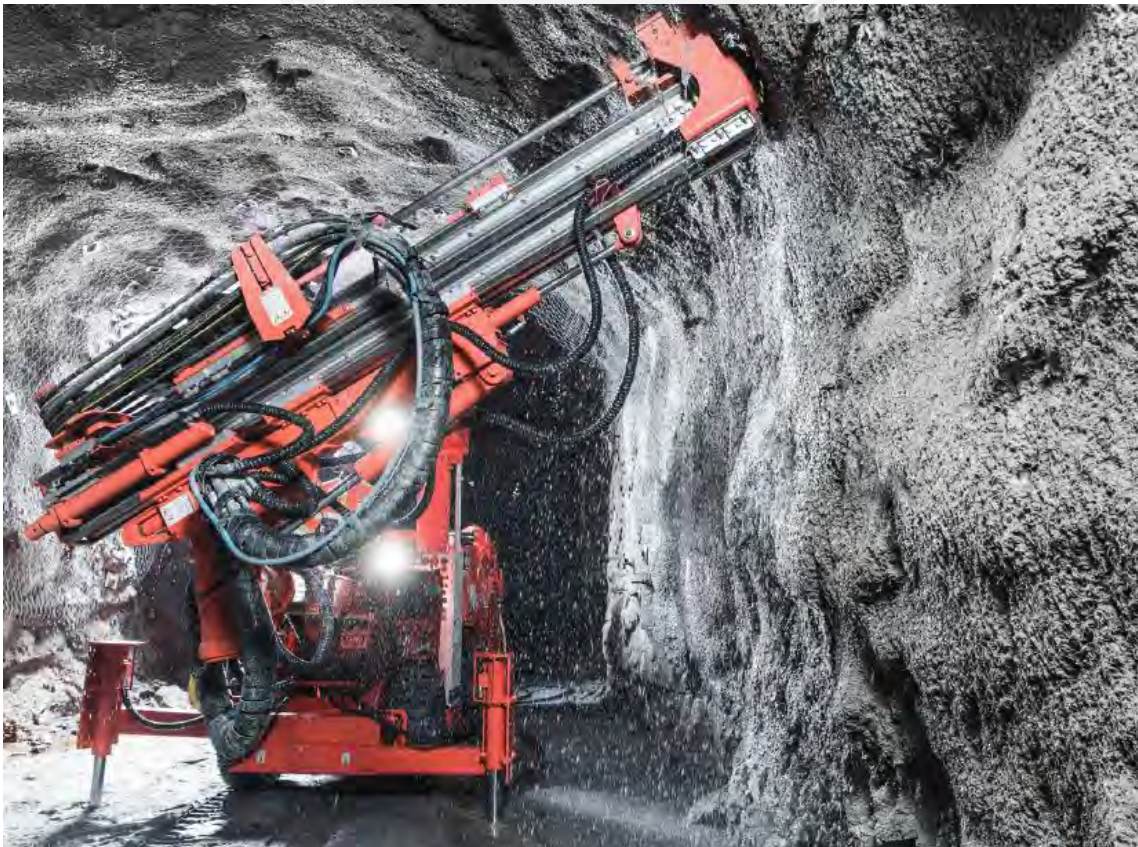
Imagen 4: Equipo de Perforación Quasar DD210
