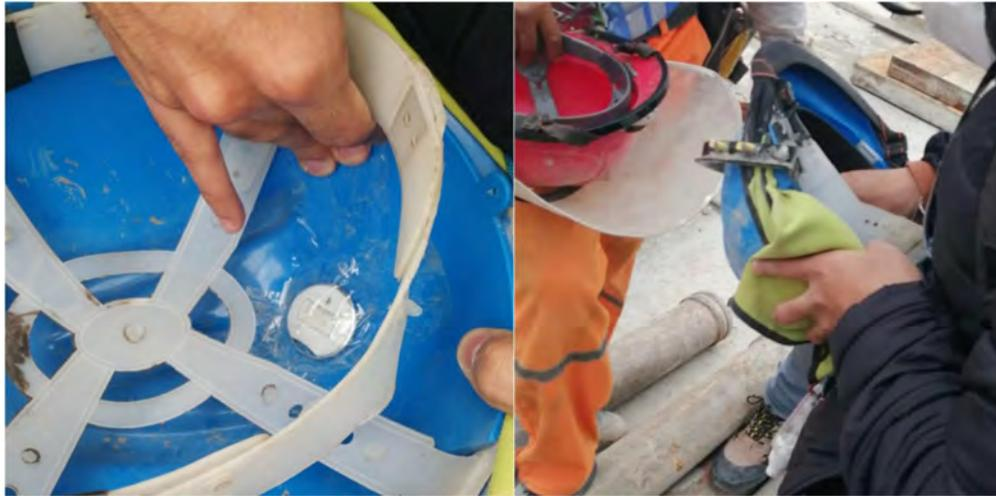
*Figura 28.* Adhesión de los sensores en los cascos de los trabajadores
