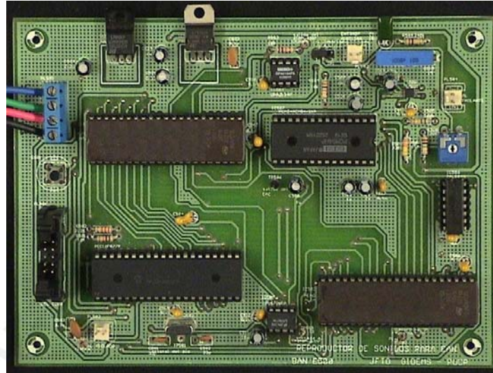
Figura 5. Circuito impreso del Reproductor de Sonidos
