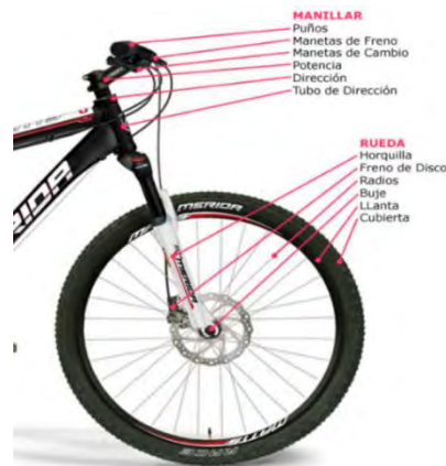
Figura 14: Partes de la rueda y tren posterior de una bicicleta MTB
