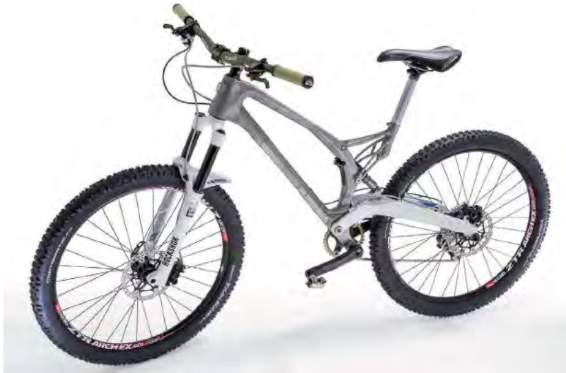
Figura 29: Bicicleta completa, con marco y soporte de sillín impresos en 3D.
