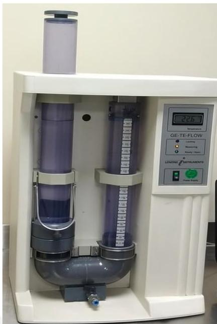
*Figura 13. Ensayo de permeabilidad en geotextil no tejido.*
