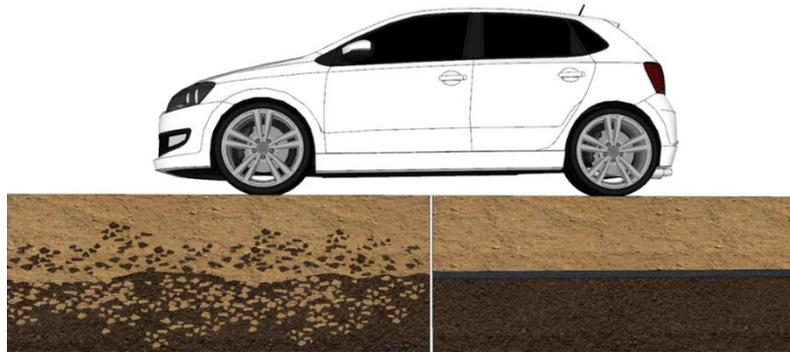
*Figura 1. Diseño comparativo de vía sin refuerzo y con refuerzo*
