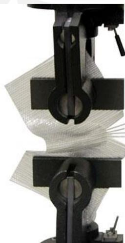
*Figura 11. Ensayo trapezoidal a geotextil tejido.*
