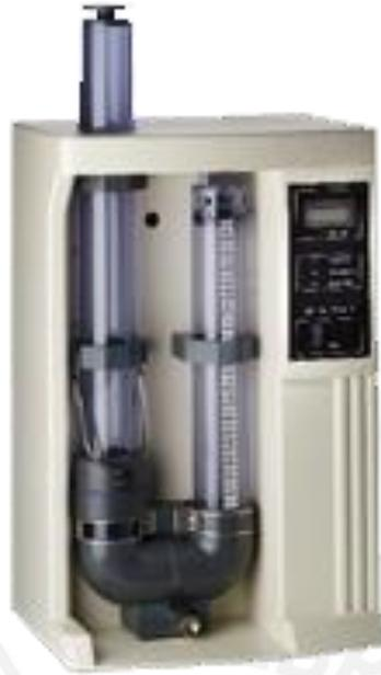
*Figura 25. Permeámetro GE TE FLOW.*
