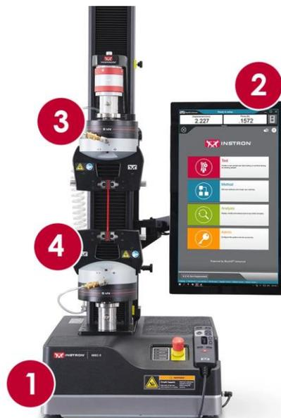
Figura 23. Máquina de Ensayo de Tensión Instron 68SC-5.
