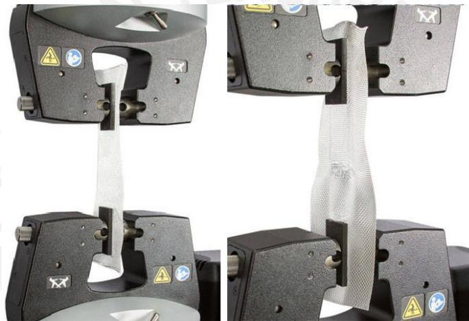
*Figura 9. Ensayo Grab en geotextil tejido.*
