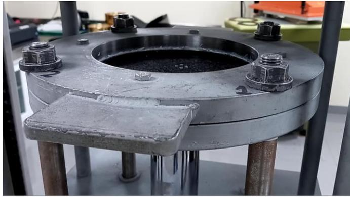
*Figura 10. Ensayo de punzonamiento CBR en geotextil no tejido.*
