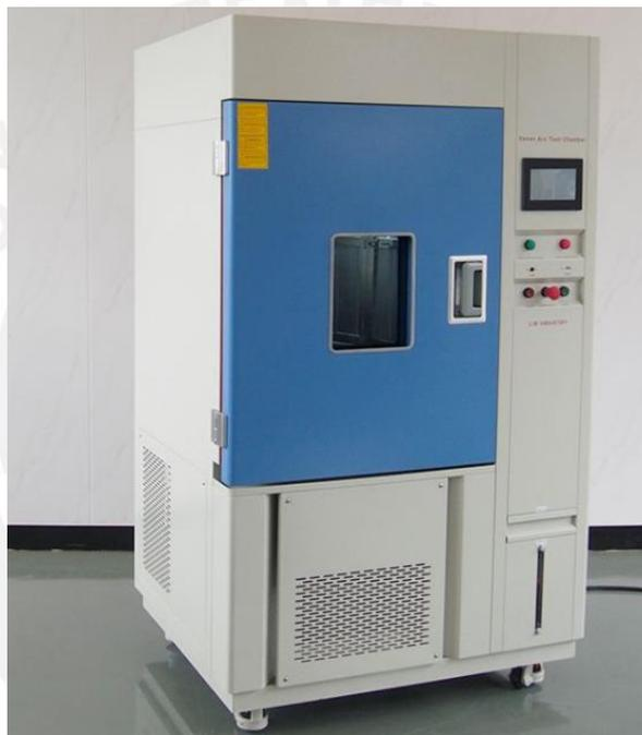
*Figura 28. Equipo de arco de Xenón.*
