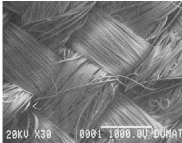
*Figura 6. Microfotografía de geotextil tejido multifilamento*
