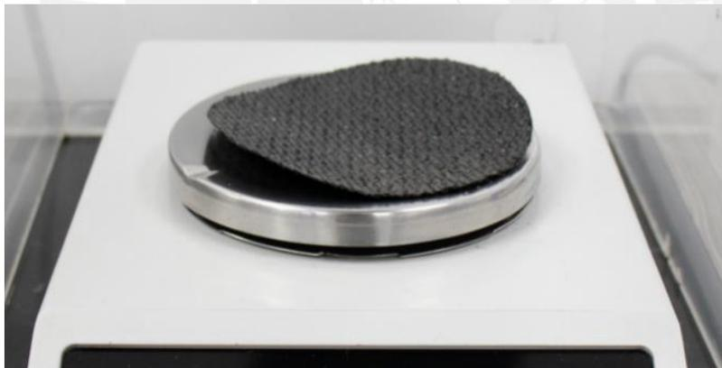
*Figura 34. Muestra del ensayo de masa por unidad de área a geotextil tejido*
