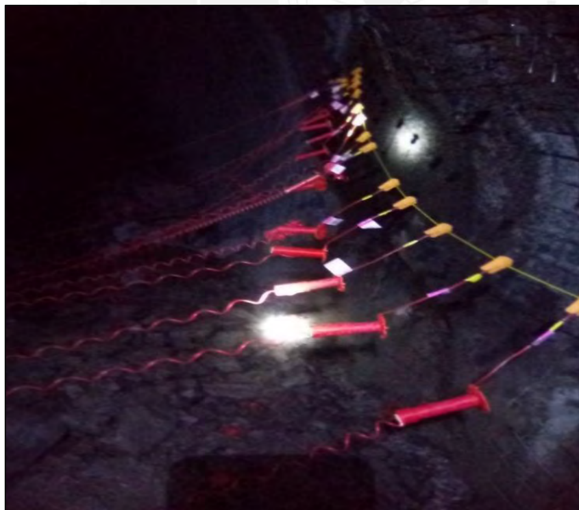
Figura 37. Conexión de detonadores electrónicos en vacío a la línea M35.
