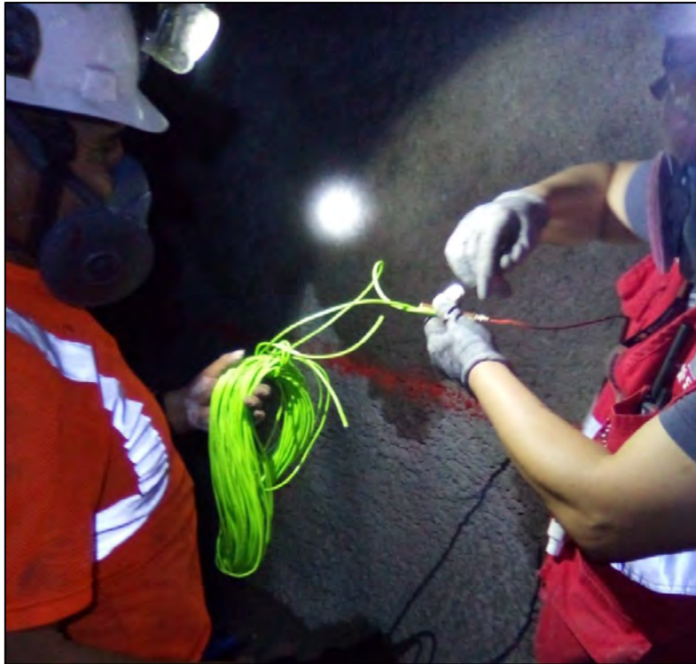
Figura 39. Verificación del amarre de la cápsula a la mecha de seguridad.
