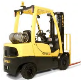
Figura 1: Montacargas con motor de combustión interna Fuente: Eurolift
