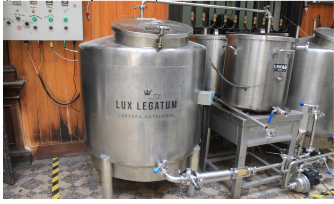
Figura AD2: Proceso de producción de la primera tanda
