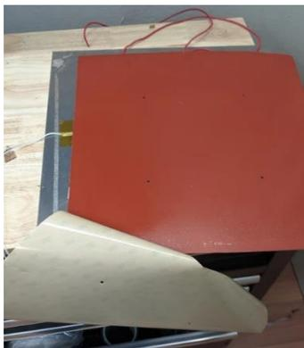
Figura B8-3: Cama caliente AC con cojín térmico. (Ender Extender, s.f.).
