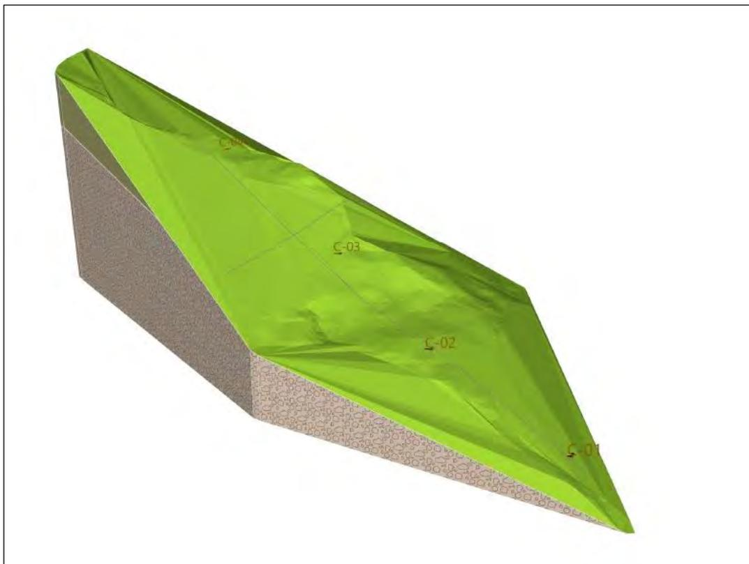
Figura 17. Modelado estratigráfico del proyecto en el programa Geo5
