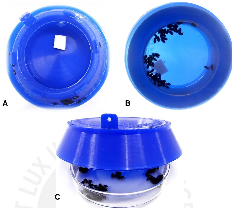
Figura 25. Adultos experimentados atrapados en las biotrapas después de los ensayos de su validación. Vista inferior (A, sin placa Petri; B, con Placa Petri en la base) y (C) superior de la biotrampa.
