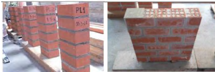
Figura 4. Pilas y muretes de albañilería simple
