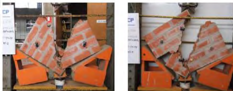
Figura 21. Fallas en dos muretes ensayados
