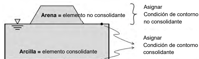
Figura 4.5. Ejemplo de elemento a consolidar (arcilla) y elemento no consolidable (arena). Fuente: MIDAS (2020).
