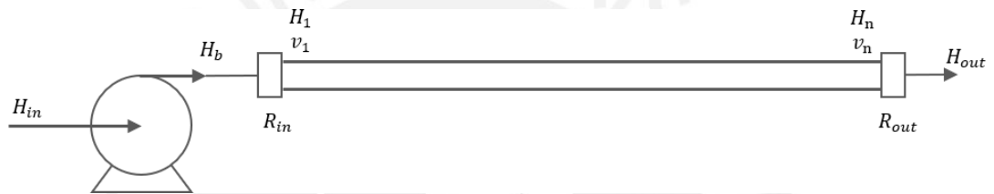
Figura 2.3. Sistema bomba – tubería
