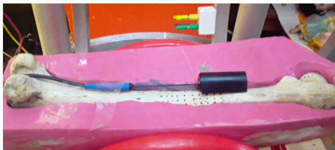
(c) Fantoma que contiene al hueso y sobre este el sensor junto con el desmagnetizador
