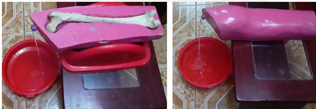
Figura 3.38: La figura de la izquierda es la base de acrílico donde se coloca el fémur, entre la superficie del hueso y la del acrílico se tienen espacios pequeños para colocar los sensores Hall. La figura de la derecha es la tapa del acrílico rellena con agua. La base y la tapa forman un fantoma en forma de una pierna humana. Dicho fantoma contiene agua en su interior para simular y asemejar la densidad de la musculatura humana.
