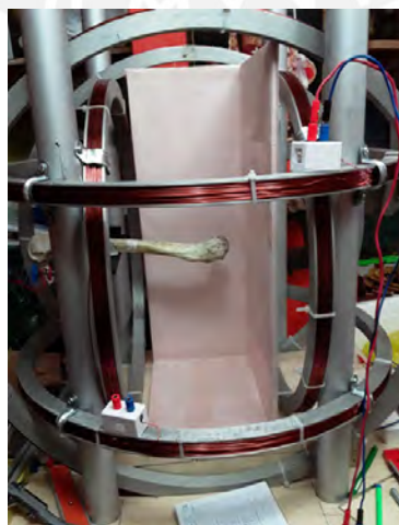
Figura 4.14: Disposición de la cabeza femoral se colocó un eje coordinado con papel milimetrado para luego ser retirado al momento de activar el campo magnético.
