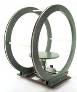
(c) bobina Helmholtz de un solo eje con porta muestras en el centro de trabajo y con alta homogeneidad de campo magnético. [104]
