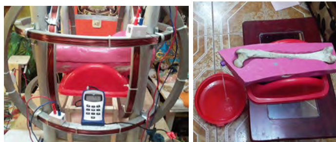
(a) Fantoma completo dentro de las bobinas (b) Fantoma retirando el agua después de las medidas
