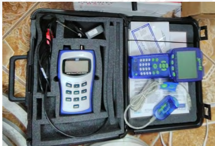
(c) Magnetómetro FW Bell y el Xplore GLX utilizados para calibrar y medir la inducción magnética
