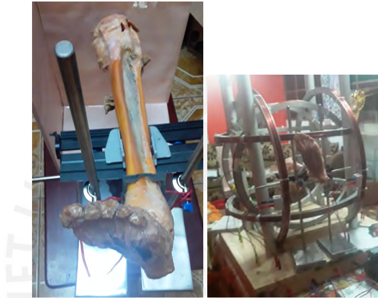
(a) Plastinado en el soporte uni- (b) Plastinado en el estimulador versal para su ubicación espa- en disposición triaxial. cial.
