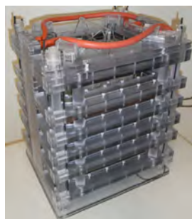
(a) PEMF para exponer una gran cantidad de muestras en condiciones controladas, sistema de exposición PEMF doble ciego. La configuración proporciona un campo magnético uniforme de hasta 2mT en un rango de frecuencia de CC a 20kHz . [102]
