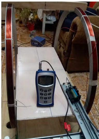
(a) En el papel milimétrico se eligió una malla de puntos y en cada punto se determinó la inducción magnética con el Gaussímetro FW BELL 5180
