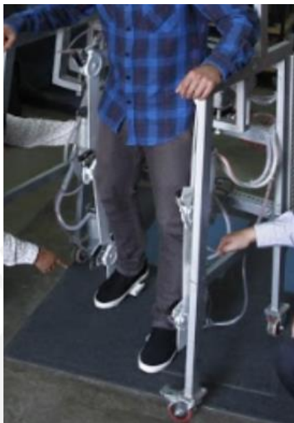
Fig. 1.1. Exoesqueleto de rehabilitación desarrollado en la PUCP [PUCP, 2016].
