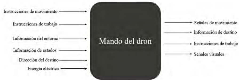
Figura 3.2. Modelo de caja negra del mando del dron. Elaboración propia.
