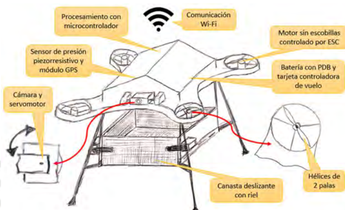
Figura 3.10. Bosquejo de la alternativa 2 para el dron teleoperado. Elaboración propia.
