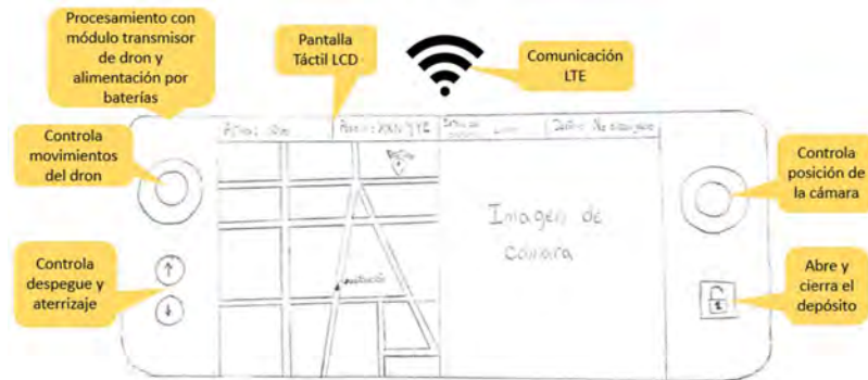
Figura 3.6. Bosquejo de la alternativa 2 para el mando de control. Elaboración propia.
