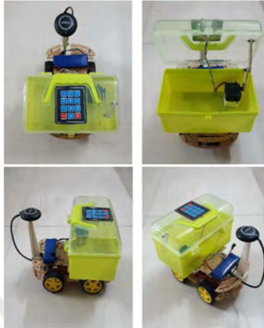
Figura 2.1. Prototipo de Robot autónomo de Delivery . Adaptado de Abrar, Islam y Shanto, 2020, p. 2.
