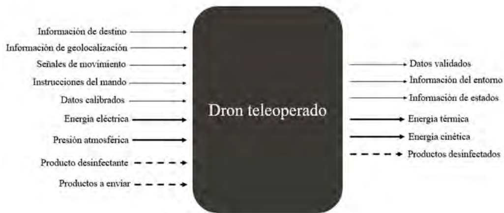
Figura 3.1. Modelo de caja negra del dron. Elaboración propia.
