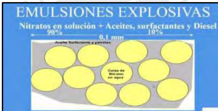
Figura 7. Composición de la emulsión explosiva.
