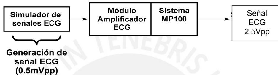
Figura 3.1. Diagrama de bloques de la etapa de generación de la señal ECG
