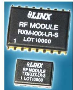
Para el diseño de la presente tesis se emplean los módulos LINX por su fácil implementación, por la tasa de transferencia de 10000bps (serie LR) que es suficiente para transmitir la señal ECG sin distorsión y principalmente porque su uso ha sido aprobado en equipos biomédicos. Para la serie LR, el módulo receptor no debe estar a una distancia mayor de 1Km del transmisor.
