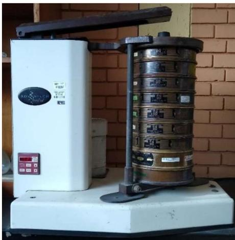
*Figura 11: Máquina tamizadora Ro Tap del laboratorio de mineralurgia ubicada en la sección de Ingeniería de Minas de la Pontificia Universidad Católica del Perú*
