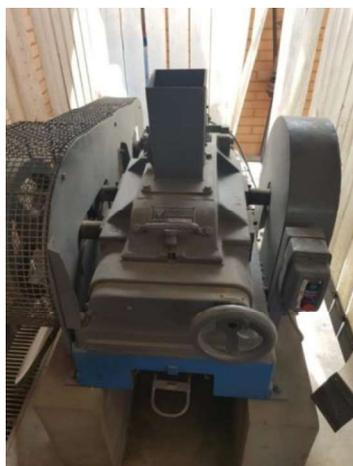
*Figura 14: Chancadora de rodillos ubicada en la sección de Ingeniería de Minas de la Pontificia Universidad Católica del Perú*
