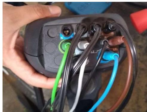
Figura 9: Conexiones de los accesorios requeridos del analizador de redes.
