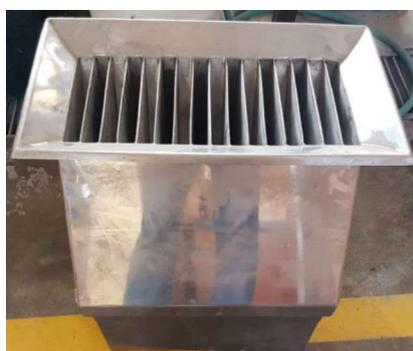
*Figura 15: Cuarteador de revólver ubicado en la sección de Ingeniería de Minas de la Pontificia Universidad Católica del Perú*
