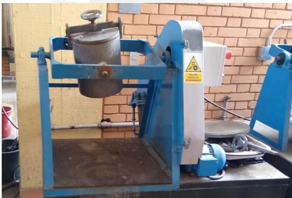
*Figura 5: Molino de bolas del laboratorio de mineralurgia ubicado en la sección de Ingeniería de Minas de la Pontificia Universidad Católica del Perú*
