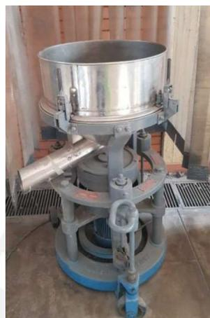
*Figura 13: Zaranda con malla N°10 ubicada en la sección de Ingeniería de Minas de la Pontificia Universidad Católica del Perú*
