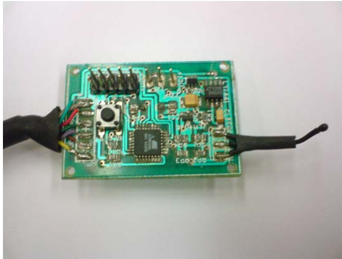
Figura 3.19 Imagen Tarjeta impresa de la Unidad de sensado - Lado anverso
