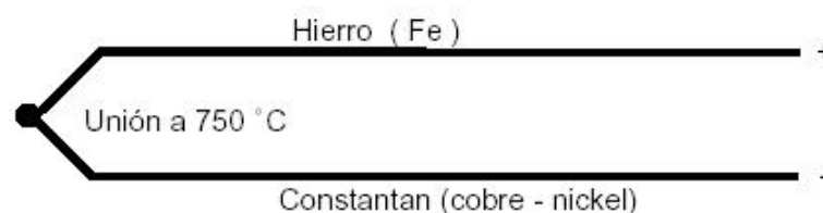
Figura 2.3 Termocupla Tipo J (Hierro, Cobre y Níquel)
