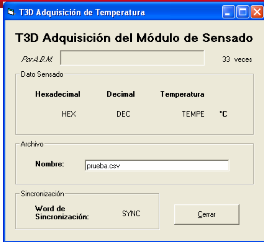
Figura 3.31 Interfaz de visualización de datos para las mediciones de temperatura
