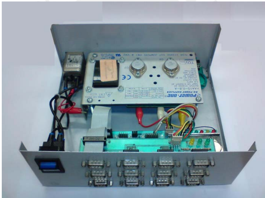
Figura 3.28 Módulo central de adquisición de datos (vista frontal)
