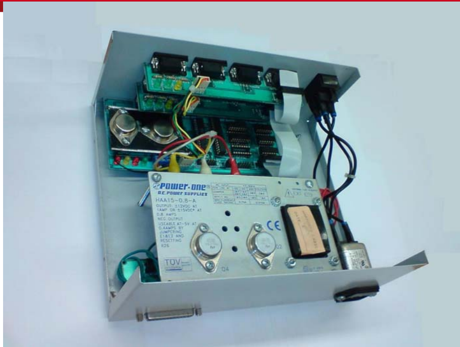
Figura 3.29 Módulo central de adquisición de datos (vista posterior)
