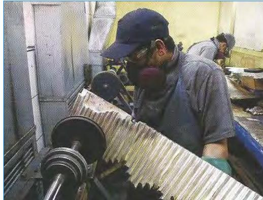
Figura 23 Operación de Pulido del Proceso de Acabado
