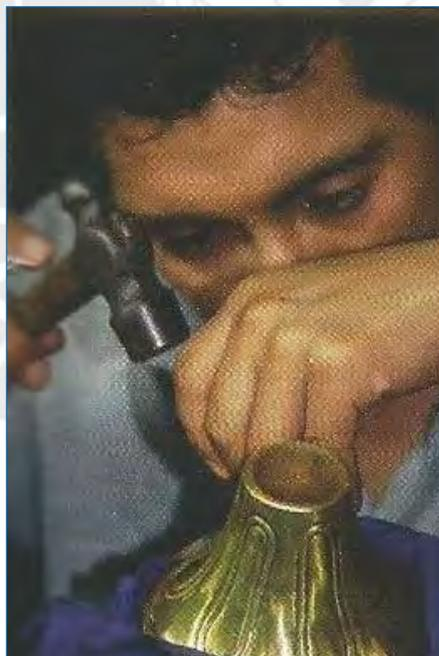
Figura 22 Operación de Tallado del Proceso de Acabado
