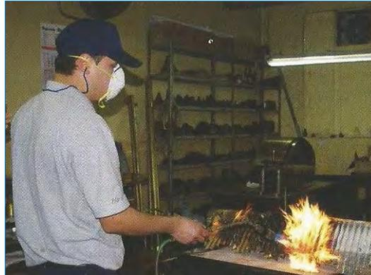
Figura 21 Proceso de Armado y Soldado
