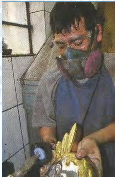
Figura 24 Operación de Pulido del Proceso de Acabado
