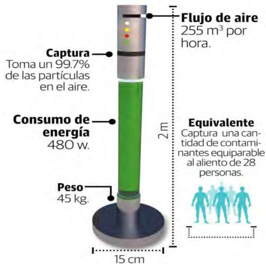
Tomado de “BiomiTech creó un sistema de filtración de aire con microalgas,” por Centro de Capacitación Eléctrica y Energías Alternas, 2021 (<https://ccee.co/>).
