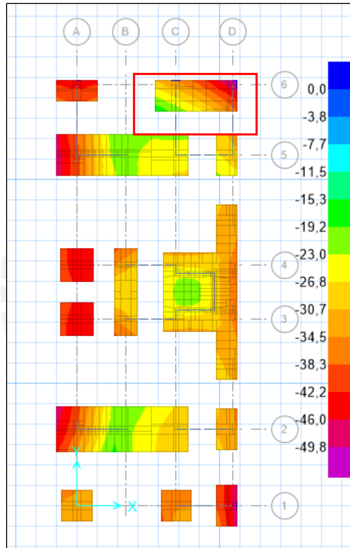
Figura 9.3.2 Esfuerzo admisible del suelo por cargas sísmicas ( \text{ton/m}^2 )
