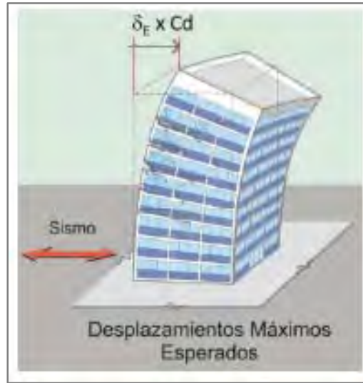
Figura 2.4. Desplazamientos máximos esperados.
