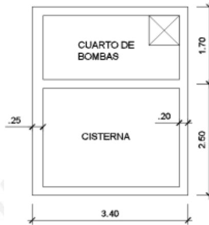
Figura 11.8. Dimensionamiento de cisterna y cuarto de bombas
