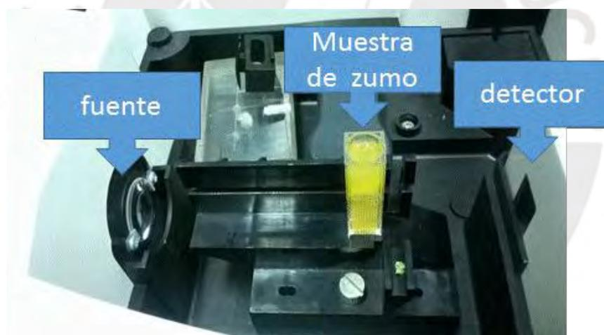
Figura 34. Arreglo experimental con el espectrofotómetro Thermo Spectronic, modelo: Helios gama.
