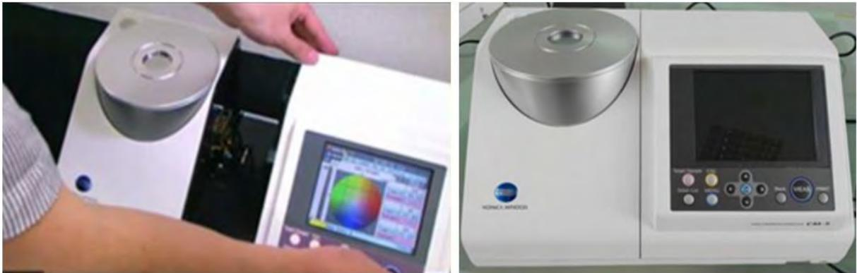
Figura 36. En la figura de la izquierda se muestra el compartimento donde se inserta la cubeta usada para la medición del color con el equipo CM 5.
