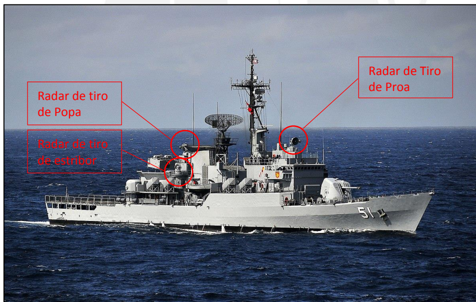
Figura 1.1.: Fragata Misilera Tipo "Lupo" con sistema de control de tiro antiaéreo Fuente: Marina de Guerra del Perú.
