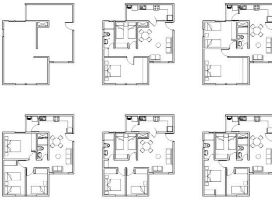
*Ilustración 47: Módulo básico y cinco diferentes alternativas de distribución de vivienda con dos o tres dormitorios.
