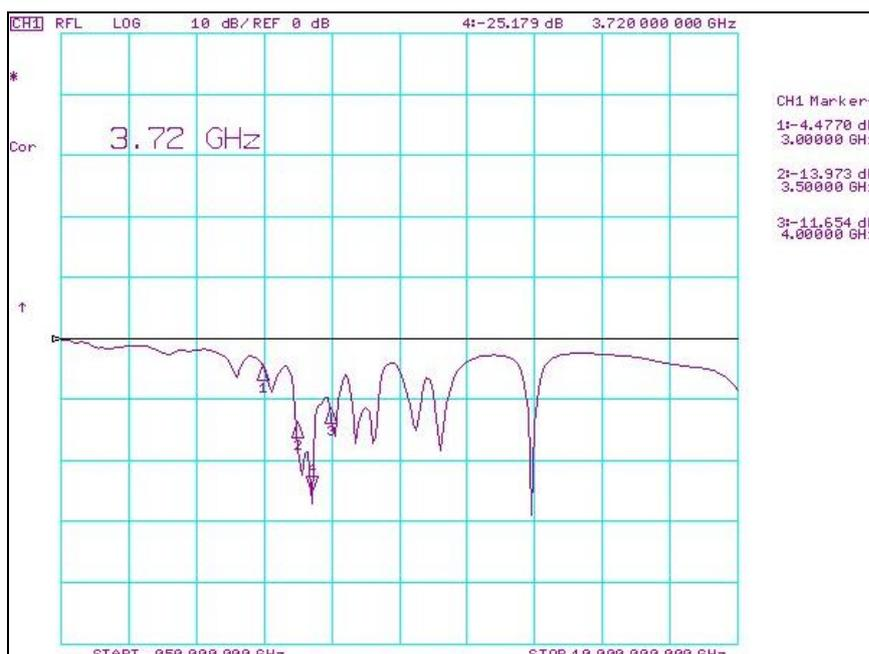
**FIGURA 3-28: PÉRDIDA DE RETORNO DE LA ANTENA LOGARÍTMICA CON SUBSTRATO VERDE**
