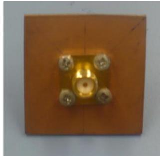
**FIGURA 3-4: INSERCIÓN DEL CONECTOR SMA EN LA PLACA**
