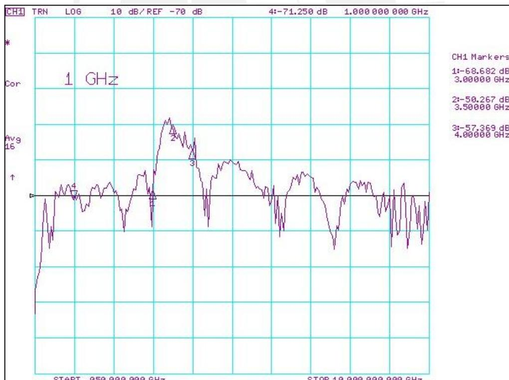
FIGURA 4-9:  $S_{21}$  ENTRE LA PLANCHA DE ACERO Y LAS ANTENAS MONOPOLO
