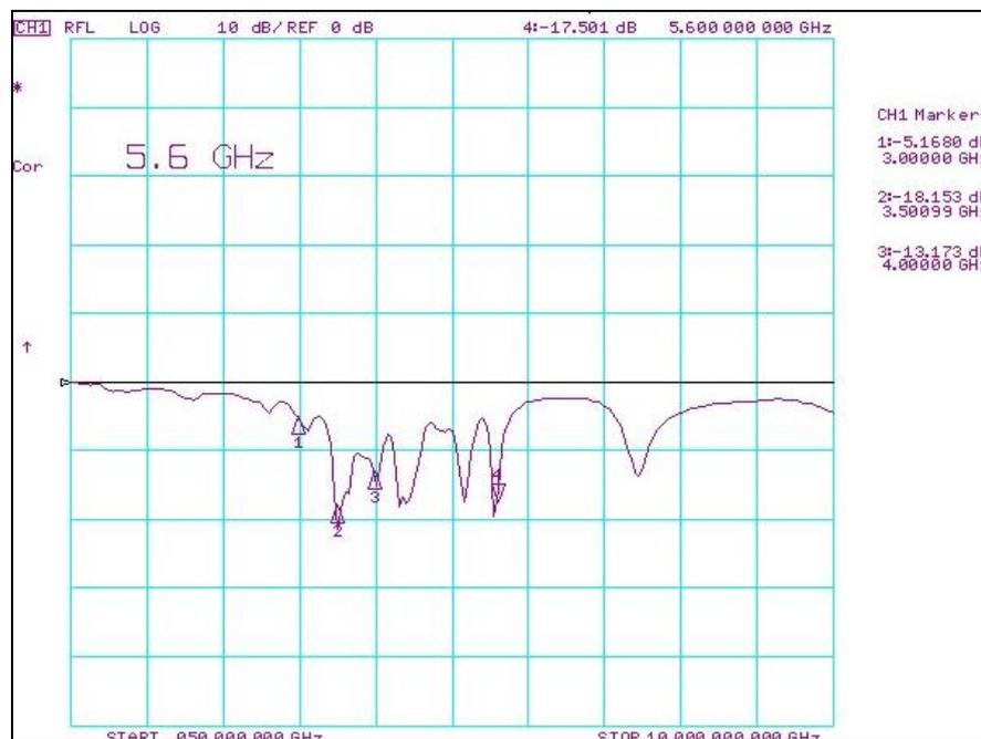
**FIGURA 3-27: PÉRDIDA DE RETORNO DE LA ANTENA LOGARÍTMICA CON SUBSTRATO BLANCO**
