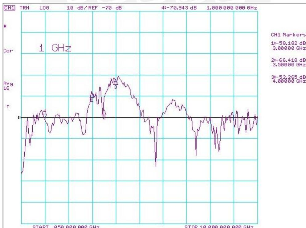
FIGURA 4-5:  $S_{21}$  ENTRE LA PLANCHA DE COBRE Y LAS ANTENAS MONOPOLO
