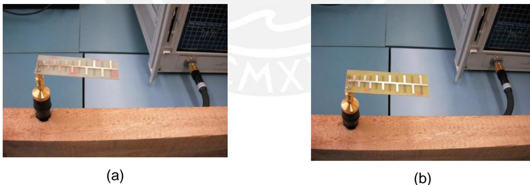
**FIGURA 3-26: MEDICIONES CON LA ANTENA MICROSTRIP LOGARÍTMICA**
