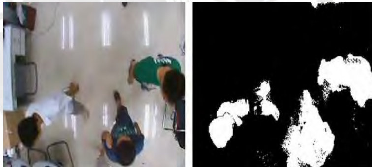
Figura 10: A la izquierda, la imagen inicial de la cámara. A la derecha, la imagen con el fondo extraído usando el algoritmo ViBe . Fuente: IEEE. [15]
