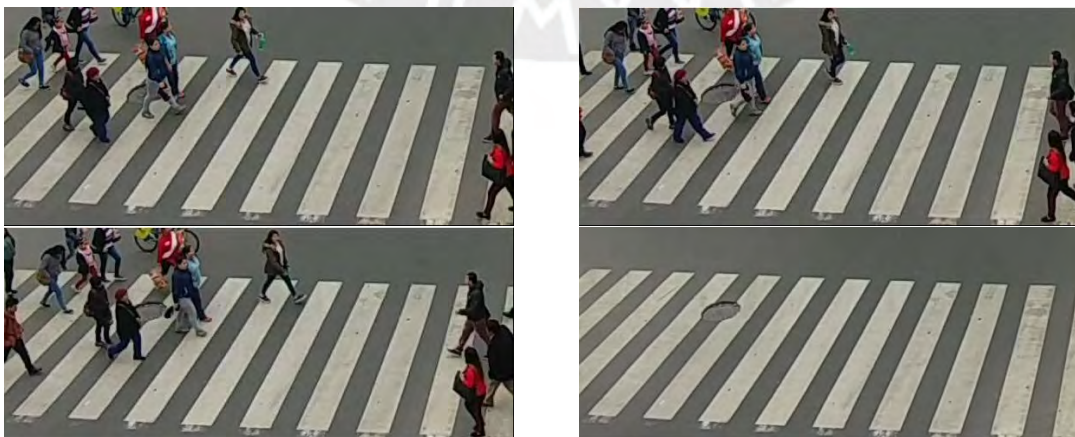
Figura 28: ejemplo del uso de filtro mediana. Arriba izquierda, derecha y abajo izquierda: cuadros del video. Abajo derecha: mediana de los 3 cuadros. Fuente: propia
