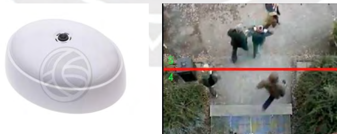
Figura 9: ejemplo de cámara IP y el resultado de cuenta personas de Mirame.net. Fuente: Cablematic.com y Mirame.net [13][14]
