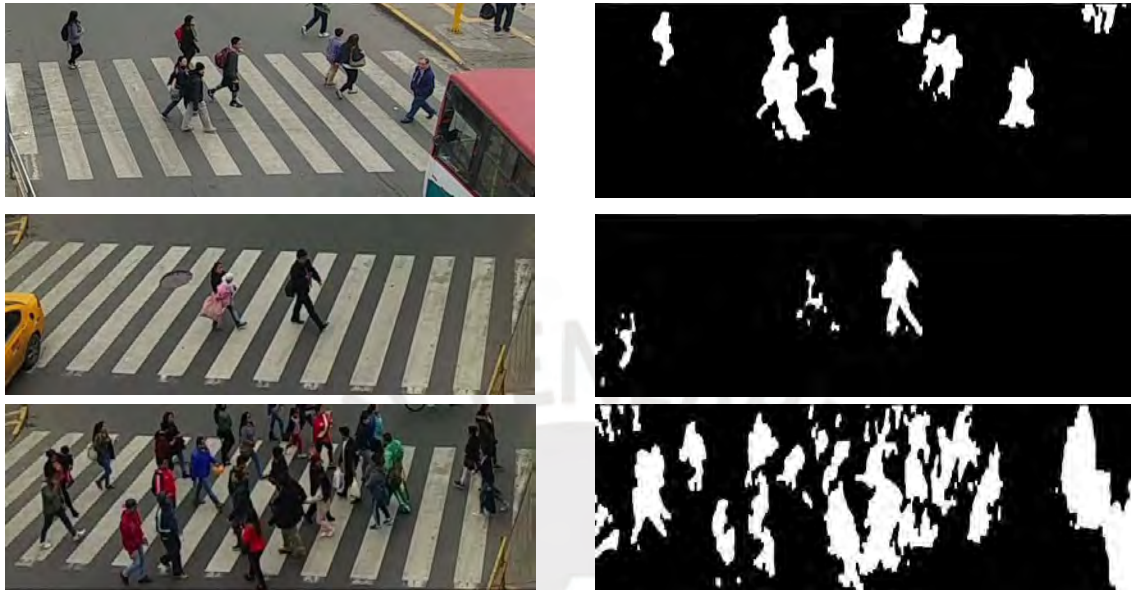
Figura 30: Resultado de la extracción de fondo para diferentes densidades. Arriba: densidad media, Medio: densidad baja, Abajo: densidad alta. Fuente: propia
