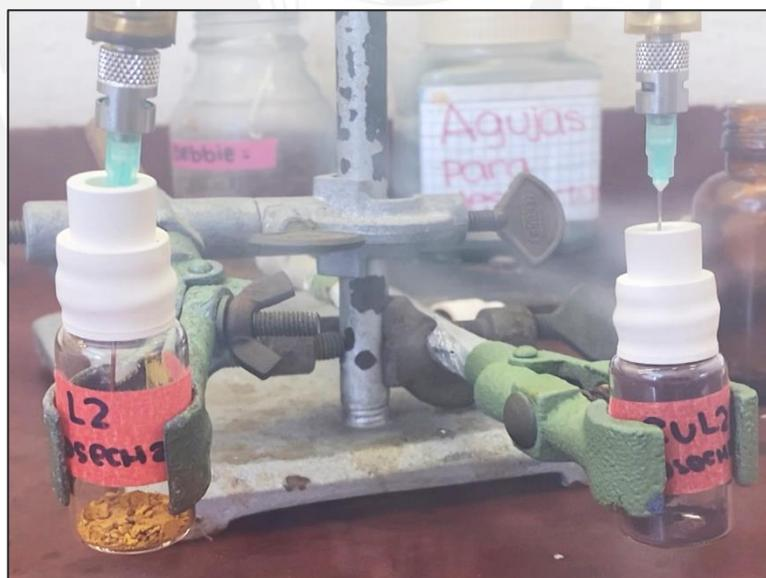
Secado al vacío de productos obtenidos, en la Figura se muestra al ligando L2 (izquierda) y al complejo CuL2 (derecha)
