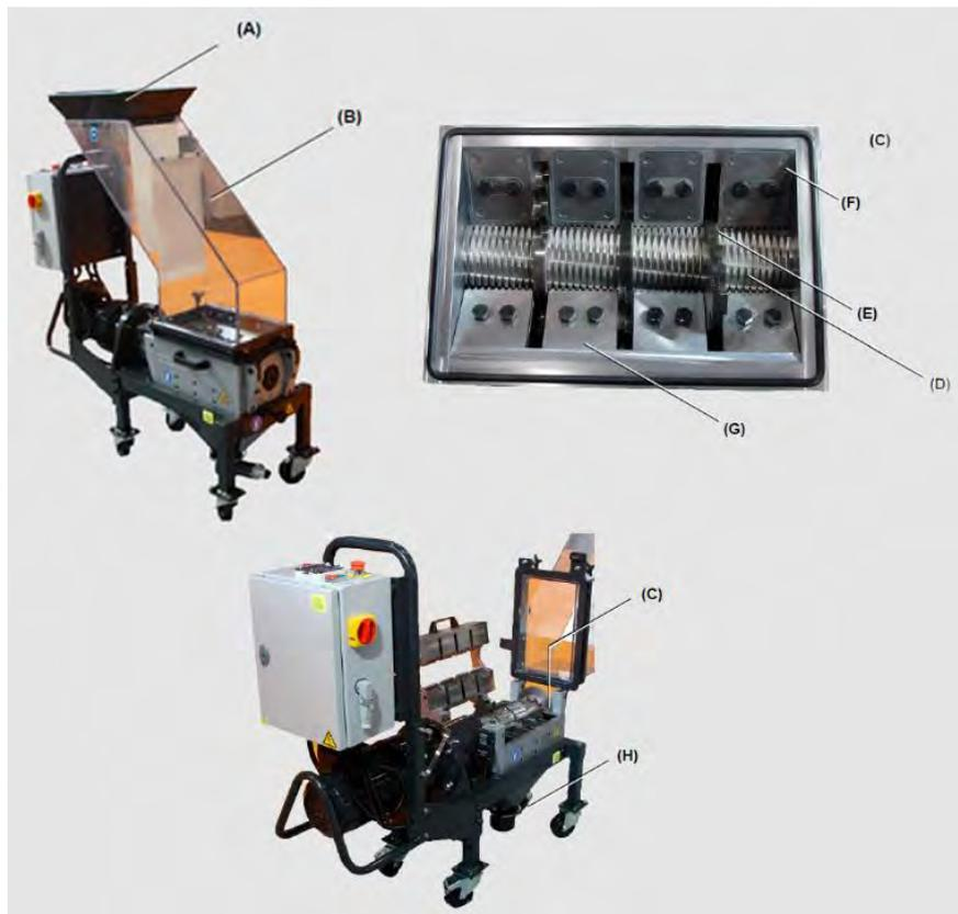
Figura 4.9. Granulador de cuchillas de múltiples dientes y ganchos de alimentación (CONAIR, 2017)
