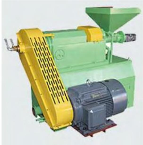
Figura 4.12. Máquina resadora de polvo fino de caucho (SUMAC, 2020).
