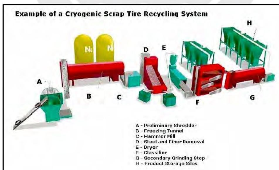
Figura 3.3. Esquema de una planta criogénica de procesamiento de desechos de caucho (Reschner, 2008).
