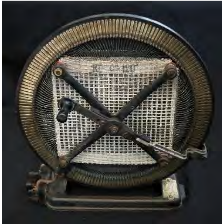
Figura 8: Fotografía de un reóstato. Utilizado para el control de las luminarias entre fines del s. XIX e inicios del s. XX. Historitec, 2019. Recuperado de https://historicttech.com/product/large-french-clemancon-theatre-lighting-rheostat-c1900/
