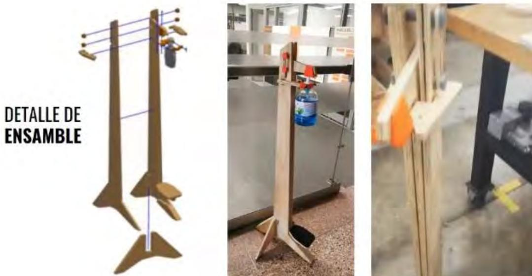
*Figura 16 Propuesta de dispensador en gel elaborada por el Fab Lab ULima*
