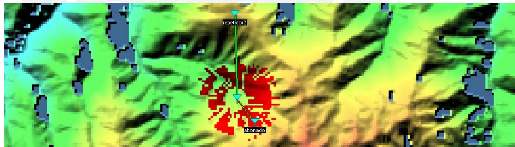
figura 5.18 Cobertura utilizando la frecuencia de 2,4GHz en Chacochi
