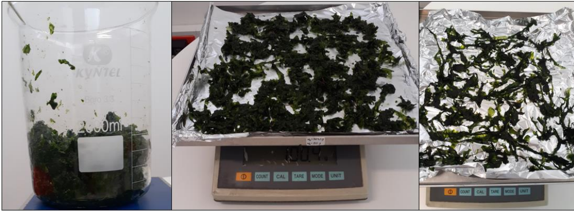
Figura 10 Algas de la especie Ulva nematoide lavadas (izquierda), pesaje de las algas húmedas (centro) y pesaje de algas secas (derecha)
