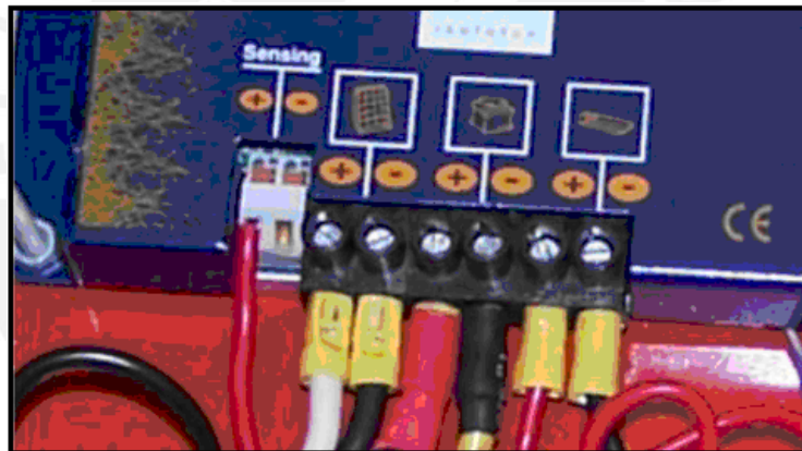
Figura 36: Conexiones de un regulador que tiene 3 entradas y 1 salida.
