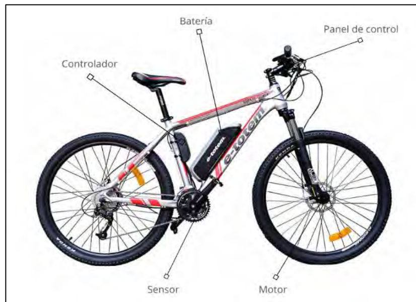
Gráfico 29. Componentes de una e-bike convencional
