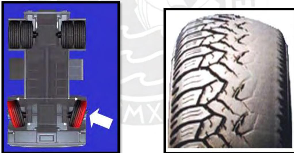
*Imagen 6 – Desgaste externo por convergencia [7]*
