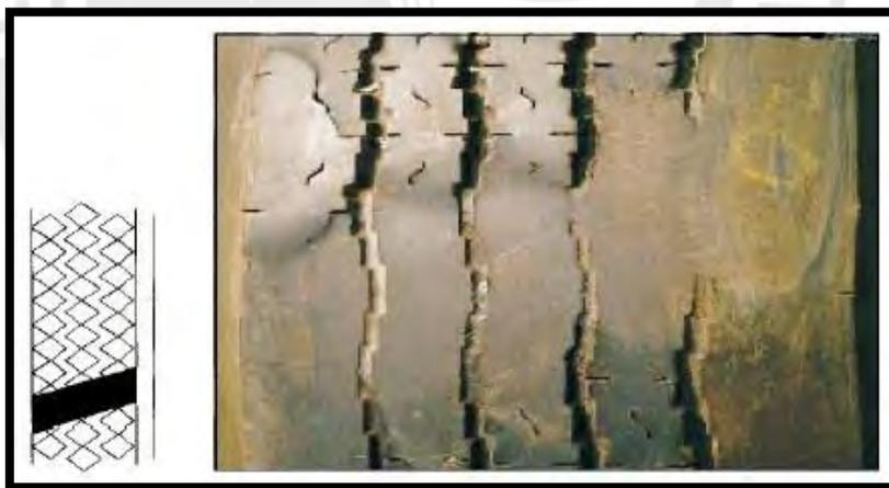
*Imagen 8 – Desgaste diagonal del neumático [7]*
