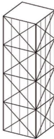
Figura 7: Esquema del sistema tubular arriostrado (Astiz, 2014).
