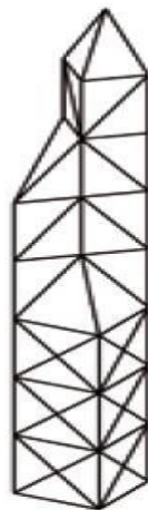
Figura 4: Esquema de una celosía espacial (Astiz, 2014).
