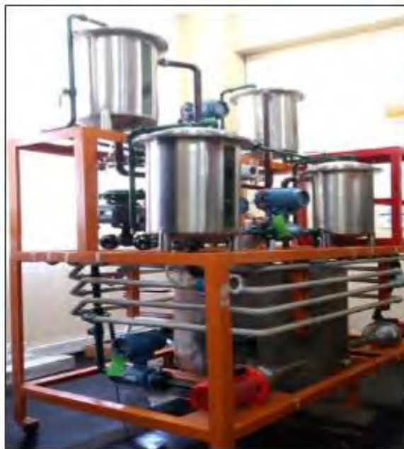
Figura 1.4. Planta piloto de cuatro tanques acoplados.
