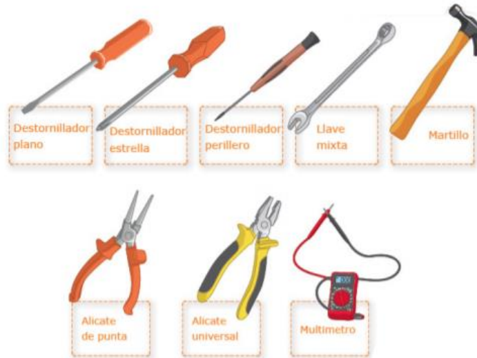
Figura 13: Herramientas necesarias para la instalación de sistemas de paneles solares. Fuente: Cooperación Alemana al Desarrollo - GIZ, 2013
