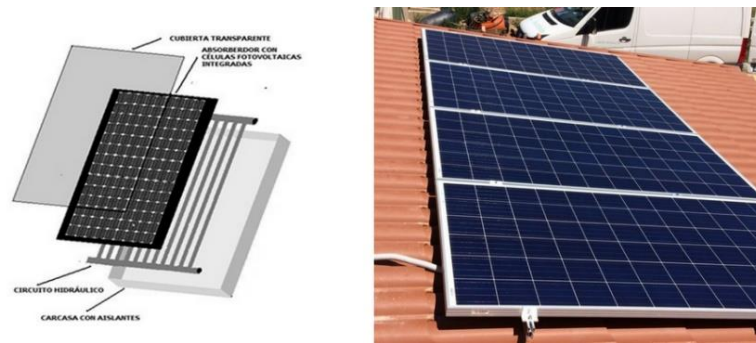
Figura 6: Paneles solares fotovoltaicos.
