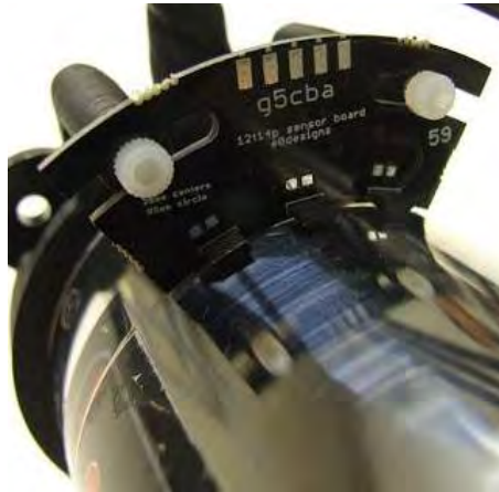
Fig. 3.12: Ejemplo del montaje de los sensores de efecto Hall sobre un motor DC sin escobillas.
