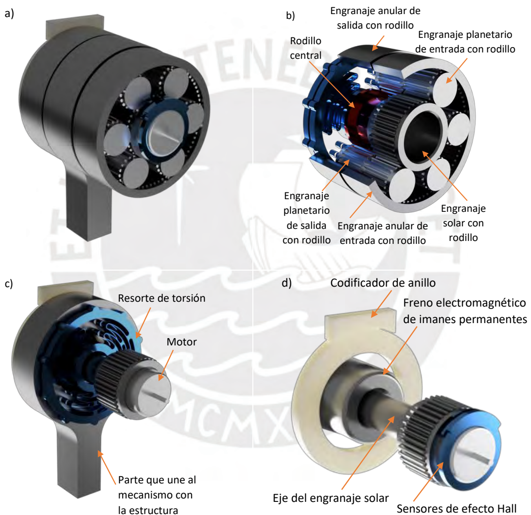
Fig. 1.9: Vistas de detalle de los componentes del sistema [Torres, 2020]
